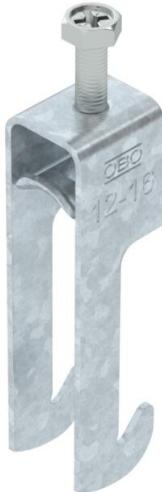
Bügelschelle mit W-Fuß, Metalldruckwanne mit gerundeten Kanten für Kabelschutz. Zur vertikalen und horizontalen Montage von 1 Einzelkabel an Winkeleisen mit 40 mm Schenkelänge. Mit 1-gängiger Schraube an Druckwanne, universeller Sechskant-Schraubenkopf SW10, mit Schlitz und Kreuzschlitz. Geeignet für Montage im Innen- und Außenbereich. Der Einsatz einer Gegenwanne wird empfohlen.
