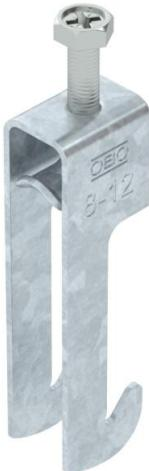
Staffa reggicavo con base a W, coppa in metallo con bordi arrotondati per proteggere il cavo. Per il montaggio verticale e orizzontale di 1 cavo singolo su profili angolari fino a < 40 mm. Con 1 vite a pressione, testa a vite esagonale universale SW10, con fessura e taglio a croce. Per il montaggio in ambienti interni ed esterni. Si consiglia di utilizzare una controcoppa.
