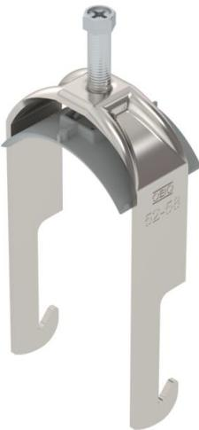
Staffa reggicavo con base a W, coppa in plastica di polipropilene. Per il montaggio verticale e orizzontale di 1 cavo singolo su profilati angolari fino a < 40 mm. Con una vite sulla coppa premente, testa della vite esagonale universale da SW10, a taglio e a croce. Per il montaggio in ambienti interni ed esterni. Si consiglia di utilizzare una controcoppa.
