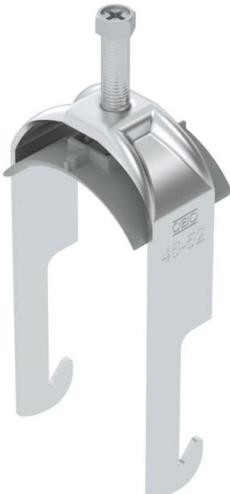
Bride de fixation avec pied W, plaque de pression en matière plastique en polypropylène. Pour montage vertical et horizontal d'1 câble individuel sur des cornières jusqu'à < 40 mm. Avec vis à 1 filet sur plaque de pression, tête de vis hexagonale universelle SW10, avec fente et empreinte cruciforme. Convient au montage en intérieur et en extérieur. L'utilisation d'une contre-plaque est recommandée.
