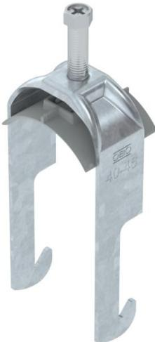
Bügelschelle mit W-Fuß, Kunststoffdruckwanne aus Polypropylen. Zur vertikalen und horizontalen Montage von 1 Einzelkabel an Winkelleisen mit 40 mm Schenkellänge. Mit 1-gängiger Schraube an Druckwanne, universeller Sechskantschraubenkopf SW10, mit Schlitz und Kreuzschlitz. Geeignet für Montage im Innen- und Außenbereich. Der Einsatz einer Gegenwanne wird empfohlen.
