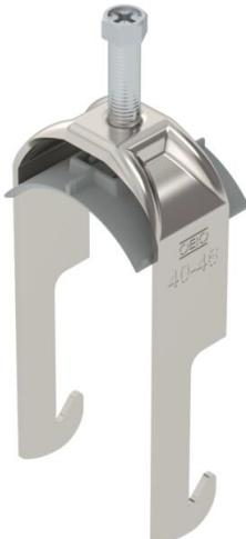
Staffa reggicavo con base a W, coppa in plastica di polipropilene. Per il montaggio verticale e orizzontale di 1 cavo singolo su profilati angolari fino a < 40 mm. Con una vite sulla coppa premente, testa della vite esagonale universale da SW10, a taglio e a croce. Per il montaggio in ambienti interni ed esterni. Si consiglia di utilizzare una controcoppa.
