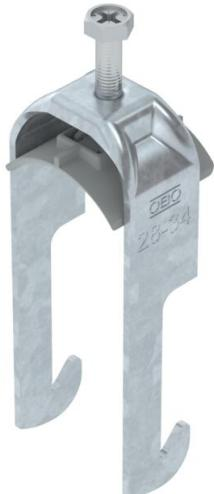
Bride de fixation avec pied W, plaque de pression en matière plastique en polypropylène. Pour montage vertical et horizontal d'1 câble individuel sur des cornières jusqu'à < 40 mm. Avec vis à 1 filet sur plaque de pression, tête de vis hexagonale universelle SW10, avec fente et empreinte cruciforme. Convient au montage en intérieur et en extérieur. L'utilisation d'une contre-plaque est recommandée.
