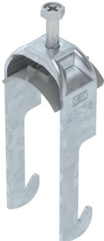
Bügelschelle mit W-Fuß, Kunststoffdruckwanne aus Polypropylen. Zur vertikalen und horizontalen Montage von 1 Einzelkabel an Winkelleisen mit 40 mm Schenkellänge. Mit 1-gängiger Schraube an Druckwanne, universeller Sechskantschraubenkopf SW10, mit Schlitz und Kreuzschlitz. Geeignet für Montage im Innen- und Außenbereich. Der Einsatz einer Gegenwanne wird empfohlen.
