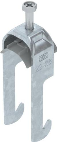
Staffa reggicavo con base a W, coppa in plastica di polipropilene. Per il montaggio verticale e orizzontale di 1 cavo singolo su profilati angolari fino a < 40 mm. Con una vite sulla coppa premente, testa della vite esagonale universale da SW10, a taglio e a croce. Per il montaggio in ambienti interni ed esterni. Si consiglia di utilizzare una controcoppa.
