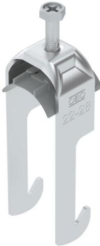
Bügelschelle mit W-Fuß, Kunststoffdruckwanne aus Polypropylen. Zur vertikalen und horizontalen Montage von 1 Einzelkabel an Winkelleisen mit 40 mm Schenkellänge. Mit 1-gängiger Schraube an Druckwanne, universeller Sechskantschraubenkopf SW10, mit Schlitz und Kreuzschlitz. Geeignet für Montage im Innen- und Außenbereich. Der Einsatz einer Gegenwanne wird empfohlen.
