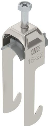
Staffa reggicavo con base a W, coppa in plastica di polipropilene. Per il montaggio verticale e orizzontale di 1 cavo singolo su profilati angolari fino a < 40 mm. Con una vite sulla coppa premente, testa della vite esagonale universale da SW10, a taglio e a croce. Per il montaggio in ambienti interni ed esterni. Si consiglia di utilizzare una controcoppa.
