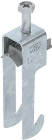
Staffa reggicavo con base a W, coppa in plastica di polipropilene. Per il montaggio verticale e orizzontale di 1 cavo singolo su profilati angolari fino a < 40 mm. Con una vite sulla coppa premente, testa della vite esagonale universale da SW10, a taglio e a croce. Per il montaggio in ambienti interni ed esterni. Si consiglia di utilizzare una controcoppa.
