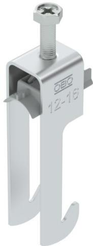
Bügelschelle mit W-Fuß, Kunststoffdruckwanne aus Polypropylen. Zur vertikalen und horizontalen Montage von 1 Einzelkabel an Winkelleisen mit 40 mm Schenkellänge. Mit 1-gängiger Schraube an Druckwanne, universeller Sechskantschraubkopf SW10, mit Schlitz und Kreuzschlitz. Geeignet für Montage im Innen- und Außenbereich. Der Einsatz einer Gegenwanne wird empfohlen.
