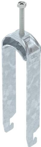
Staffa reggicavo con ancoraggio tipo U, coppa plastica in polipropilene. Per il montaggio verticale e orizzontale di 1 cavo singolo su profilato a C con scanalatura di larghezza 18 - 22 mm. Dotata di vite SW10 per il serraggio della coppa tramite testa esagonale o intaglio a croce. Per il montaggio in ambiente interno ed esterno. Separazione dei due cavi garantiti dalla coppa doppia. Si raccomanda l'uso della controcoppa, da ordinare separatamente.
