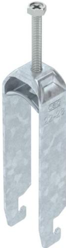
Bügelschelle mit U-Fuß, Metalldruckwanne mit gerundeten Kanten für Kabelschutz. Zur vertikalen und horizontalen Montage von 3 Einzelkabeln an C-Profil-schiene. Für Schlitzweite 18 - 22 mm. Mit 1-gängiger Schraube an Druckwanne, universeller Sechskant-Schraubenkopf SW10, mit Schlitz und Kreuzschlitz. Geeignet für Montage im Innen- und Außenbereich. Mehrere Kabel sollten durch Doppelwannen getrennt werden. Der Einsatz einer Gegenwanne wird empfohlen.
