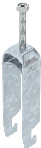
Staffa reggicavo con ancoraggio tipo U, coppa plastica in polipropilene. Per il montaggio verticale e orizzontale di 1 cavo singolo su profilato a C con scanalatura di larghezza 18 - 22 mm. Dotata di vite SW10 per il serraggio della coppa tramite testa esagonale o intaglio a croce. Per il montaggio in ambiente interno ed esterno. Separazione dei due cavi garantiti dalla coppa doppia. Si raccomanda l'uso della controcoppa, da ordinare separatamente.
