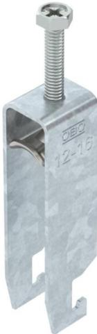
Bügelschelle mit U-Fuß, Metalldruckwanne mit gerundeten Kanten für Kabelschutz. Zur vertikalen und horizontalen Montage von 3 Einzelkabeln an C-Profilsschiene. Für Schlitzweite 18 - 22 mm. Mit 1-gängiger Schraube an Druckwanne, universeller Sechskant-Schraubenhkopf SW10, mit Schlitz und Kreuzschlitz. Geeignet für Montage im Innen- und Außenbereich. Mehrere Kabel sollten durch Doppelwannen getrennt werden. Der Einsatz einer Gegenwanne wird empfohlen.
