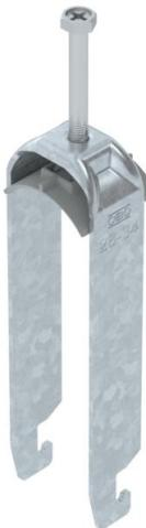
Bügelschelle mit U-Fuß, Kunststoffdruckwanne aus Polypropylen. Zur vertikalen und horizontalen Montage von 3 Einzelkabeln an C-Profilschiene. Für Schlitzweite 18 mm oder 22 mm. Mit 1-gängiger Schraube an Druckwanne, universeller Sechskant-Schraubenkopf SW10, mit Schlitz und Kreuzschlitz. Geeignet für Montage im Innen- und Außenbereich. Mehrere Kabel sollten durch Doppelwanne getrennt werden. Der Einsatz einer Gegenwanne wird empfohlen.
