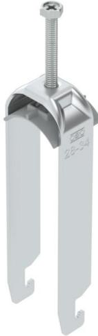
Bügelschelle mit U-Fuß, Kunststoffdruckwanne aus Polypropylen. Zur vertikalen und horizontalen Montage von 3 Einzelkabeln an C-Profilschiene. Für Schlitzweite 18 - 22 mm. Mit 1-gängiger Schraube an Druckwanne, universeller Sechskantschraubenkopf SW10, mit Schlitz und Kreuzschlitz. Geeignet für Montage im Innen- und Außenbereich. Mehrere Kabel sollten durch Doppelwannen getrennt werden. Der Einsatz einer Gegenwanne wird empfohlen.
