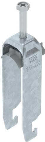
Staffa reggicavo con base a U, coppa in plastica di polipropilene. Per il montaggio verticale e orizzontale di 3 cavi singoli su profilato a C. Per dimensioni dell'asola di 18 mm o 22 mm. Con una vite sulla coppa premente, testa della vite esagonale universale da SW10, a taglio e a croce. Per il montaggio in ambienti interni ed esterni. Più cavi dovrebbero essere separati da coppe doppie. Si consiglia di utilizzare una controcoppa.
