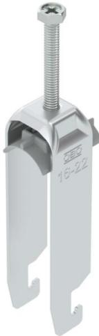
Staffa reggicavo con ancoraggio tipo U, coppa in plastica in polipropilene. Per il montaggio verticale e orizzontale di 3 cavi singoli su profilato a C. Per dimensioni scanalatura di 18-22 mm. Con coppa di pressione, testa a vite esagonale universale SW10, intaglio a croce e a taglio. Per il montaggio in ambienti interni ed esterni. Separazione tra due cavi grazie alla coppa doppia. Si raccomanda l'uso della controcoppa.
