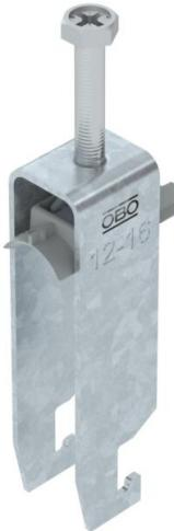
Staffa reggicavo con base a U, coppa in plastica di polipropilene. Per il montaggio verticale e orizzontale di 3 cavi singoli su profilato a C. Per dimensioni dell'asola di 18 mm o 22 mm. Con una vite sulla coppa premente, testa della vite esagonale universale da SW10, a taglio e a croce. Per il montaggio in ambienti interni ed esterni. Più cavi dovrebbero essere separati da coppe doppie. Si consiglia di utilizzare una controcoppa.
