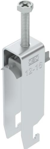
Staffa reggicavo con ancoraggio tipo U, coppa in plastica in polipropilene. Per il montaggio verticale e orizzontale di 3 cavi singoli su profilato a C. Per dimensioni scanalatura di 18-22 mm. Con coppa di pressione, testa a vite esagonale universale SW10, intaglio a croce e a taglio. Per il montaggio in ambienti interni ed esterni. Separazione tra due cavi grazie alla coppa doppia. Si raccomanda l'uso della controcoppa.
