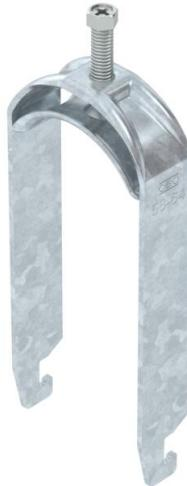
Bügelschelle mit U-Fuß, Metalldruckwanne mit gerundeten Kanten für Kabelschutz. Zur vertikalen und horizontalen Montage von 2 Einzelkabeln an C-Profil-schiene. Für Schlitzweite 18 - 22 mm. Mit 1-gängiger Schraube an Druckwanne, universeller Sechskant-Schraubenkopf SW10, mit Schlitz und Kreuzschlitz. Geeignet für Montage im Innen- und Außenbereich. Mehrere Kabel sollten durch Doppelwannen getrennt werden. Der Einsatz einer Gegenwanne wird empfohlen.
