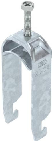
Staffa reggicavo con ancoraggio tipo U, coppa in metallo con bordi arrotondati a protezione del cavo. Per il montaggio verticale e orizzontale di 1 cavo singolo su profilato a C con scanalatura di larghezza 18 - 22 mm. Dotata di vite SW10 per il serraggio della coppa tramite testa esagonale o intaglio a croce. Per il montaggio in ambiente interno ed esterno. Si raccomanda l'uso della controcoppa, da ordinare separatamente.
