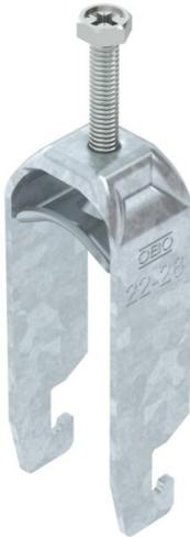
Staffa reggicavo con ancoraggio tipo U, coppa in metallo con bordi arrotondati a protezione del cavo. Per il montaggio verticale e orizzontale di 1 cavo singolo su profilato a C con scanalatura di larghezza 18 - 22 mm. Dotata di vite SW10 per il serraggio della coppa tramite testa esagonale o intaglio a croce. Per il montaggio in ambiente interno ed esterno. Si raccomanda l'uso della controcoppa, da ordinare separatamente.
