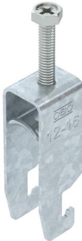
Bügelschelle mit U-Fuß, Metalldruckwanne mit gerundeten Kanten für Kabelschutz. Zur vertikalen und horizontalen Montage von 2 Einzelkabeln an C-Profil-schiene. Für Schlitzweite 18 - 22 mm. Mit 1-gängiger Schraube an Druckwanne, universeller Sechskant-Schraubenkopf SW10, mit Schlitz und Kreuzschlitz. Geeignet für Montage im Innen- und Außenbereich. Mehrere Kabel sollten durch Doppelwannen getrennt werden. Der Einsatz einer Gegenwanne wird empfohlen.
