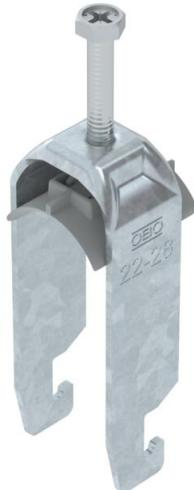
Staffa reggicavo con base a U, coppa in plastica di polipropilene. Per il montaggio verticale e orizzontale di 2 cavi singoli su profilato a C. Per dimensioni dell'asola di 18 - 22 mm. Con una vite sulla coppa premente, testa della vite esagonale universale da SW10, a taglio e a croce. Per il montaggio in ambienti interni ed esterni. Più cavi dovrebbero essere separati da coppe doppie. Si consiglia di utilizzare una controcoppa.
