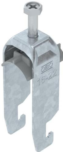
Staffa reggicavo con base a U, coppa in plastica di polipropilene. Per il montaggio verticale e orizzontale di 2 cavi singoli su profilato a C. Per dimensioni dell'asola di 18 - 22 mm. Con una vite sulla coppa premente, testa della vite esagonale universale da SW10, a taglio e a croce. Per il montaggio in ambienti interni ed esterni. Più cavi dovrebbero essere separati da coppe doppie. Si consiglia di utilizzare una controcoppa.
