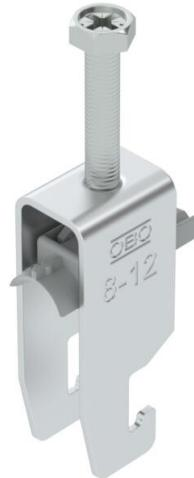
Staffa reggicavo con ancoraggio tipo U, coppa in plastica in polipropilene. Per il montaggio verticale e orizzontale di 2 cavi singoli su profilato a C. Per dimensioni scanalatura di 18-22 mm. Con coppa di pressione, testa a vite esagonale universale SW10, intaglio a croce e a taglio. Per il montaggio in ambienti interni ed esterni. Separazione tra due cavi grazie alla coppa doppia. Si raccomanda l'uso della controcoppa.
