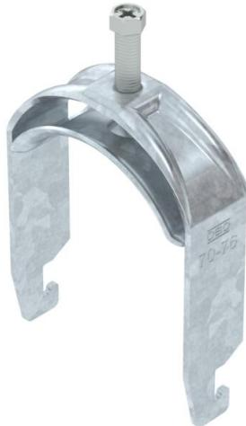
Staffa reggicavo con base a U, coppa in metallo con bordi arrotondati per proteggere il cavo. Per il montaggio verticale e orizzontale di 1 cavo singolo su profilato a C. Per dimensioni dell'asola di 18-22 mm. Con 1 vite a pressione, testa a vite esagonale universale SW10, con fessura e taglio a croce. Per il montaggio in ambienti interni ed esterni. Si consiglia di utilizzare una controcoppa.
