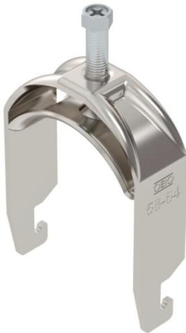
Staffa reggicavo con base a U, coppa in metallo con bordi arrotondati per proteggere il cavo. Per il montaggio verticale e orizzontale di 1 cavo singolo su profilato a C. Per dimensioni dell'asola di 18 - 22 mm. Con una vite sulla coppa premente, testa della vite esagonale universale da SW10, a taglio e a croce. Per il montaggio in ambienti interni ed esterni. Si consiglia di utilizzare una controcoppa.
