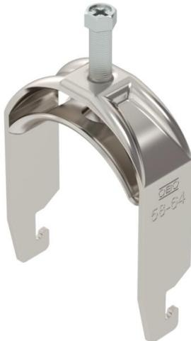
Staffa reggicavo con base a U, coppa in metallo con bordi arrotondati per proteggere il cavo. Per il montaggio verticale e orizzontale di 1 cavo singolo su profilato a C. Per dimensioni dell'asola di 18-22 mm. Con 1 vite a pressione, testa a vite esagonale universale SW10, con fessura e taglio a croce. Per il montaggio in ambienti interni ed esterni. Si consiglia di utilizzare una controcoppa.
