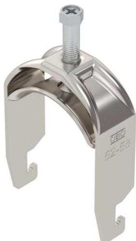
Bügelschelle mit U-Fuß, Metalldruckwanne mit gerundeten Kanten für Kabelschutz. Zur vertikalen und horizontalen Montage von 1 Einzelkabel an C-Profil-schiene. Für Schlitzweite 18 - 22 mm. Mit 1-gängiger Schraube an Druckwanne, universeller Sechskant-Schraubenkopf SW10, mit Schlitz und Kreuzschlitz. Geeignet für Montage im Innen- und Außenbereich. Der Einsatz einer Gegenwanne wird empfohlen.
