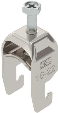
Bügelschelle mit U-Fuß, Metalldruckwanne mit gerundeten Kanten für Kabelschutz. Zur vertikalen und horizontalen Montage von 1 Einzelkabel an C-Profil-schiene. Für Schlitzweite 18 - 22 mm. Mit 1-gängiger Schraube an Druckwanne, universeller Sechskant-Schraubenkopf SW10, mit Schlitz und Kreuzschlitz. Geeignet für Montage im Innen- und Außenbereich. Der Einsatz einer Gegenwanne wird empfohlen.
