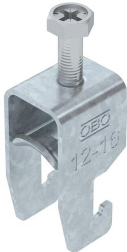
Bügelschelle mit U-Fuß, Metalldruckwanne mit gerundeten Kanten für Kabelschutz. Zur vertikalen und horizontalen Montage von 1 Einzelkabel an C-Profilschiene. Für Schlitzweite 18 - 22 mm. Mit 1-gängiger Schraube an Druckwanne, universeller Sechskant-Schraubenkopf SW10, mit Schlitz und Kreuzschlitz. Geeignet für Montage im Innen- und Außenbereich. Der Einsatz einer Gegenwanne wird empfohlen.
