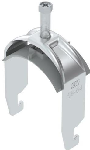
Staffa reggicavo con base a U, coppa in plastica di polipropilene. Per il montaggio verticale e orizzontale di 1 cavo singolo su profilato a C. Per dimensioni dell'asola di 18 - 22 mm. Con una vite sulla coppa premente, testa della vite esagonale universale da SW10, a taglio e a croce. Per il montaggio in ambienti interni ed esterni. Si consiglia di utilizzare una controcoppa.
