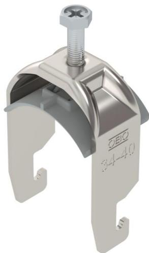
Staffa reggicavo con base a U, coppa in plastica di polipropilene. Per il montaggio verticale e orizzontale di 1 cavo singolo su profilato a C. Per dimensioni dell'asola di 18 - 22 mm. Con una vite sulla coppa premente, testa della vite esagonale universale da SW10, a taglio e a croce. Per il montaggio in ambienti interni ed esterni. Si consiglia di utilizzare una controcoppa.
