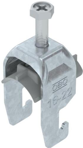
Staffa reggicavo con base a U, coppa in plastica di polipropilene. Per il montaggio verticale e orizzontale di 1 cavo singolo su profilato a C. Per dimensioni dell'asola di 18 - 22 mm. Con una vite sulla coppa premente, testa della vite esagonale universale da SW10, a taglio e a croce. Per il montaggio in ambienti interni ed esterni. Si consiglia di utilizzare una controcoppa.
