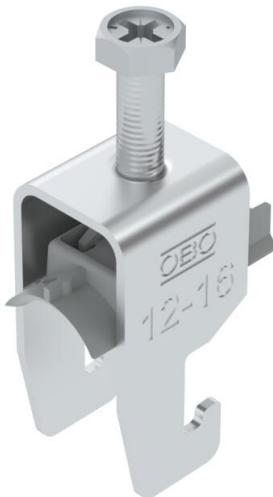
Bügelschelle mit U-Fuß, Kunststoffdruckwanne aus Polypropylen. Zur vertikalen und horizontalen Montage von 1 Einzelkabel an C-Profilschiene. Für Schlitzweite 18 - 22 mm. Mit 1-gängiger Schraube an Druckwanne, universeller Sechskantschraubekopf SW10, mit Schlitz und Kreuzschlitz. Geeignet für Montage im Innen- und Außenbereich. Der Einsatz einer Gegenwanne wird empfohlen.
