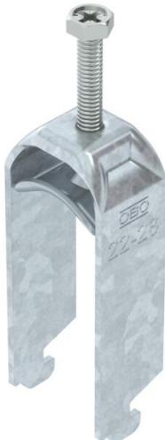
Bügelschelle mit N-Fuß, Metalldruckwanne mit gerundeten Kanten für Kabelschutz. Zur vertikalen und horizontalen Montage von 2 Einzelkabeln an C-Profil-schiene. Für Schlitzweite 11 - 12 mm. Mit 1-gängiger Schraube an Druckwanne, universeller Sechskant-Schraubenkopf SW10, mit Schlitz und Kreuzschlitz. Geeignet für Montage im Innen- und Außenbereich. Mehrere Kabel sollten durch Doppelwannen getrennt werden. Der Einsatz einer Gegenwanne wird empfohlen.
