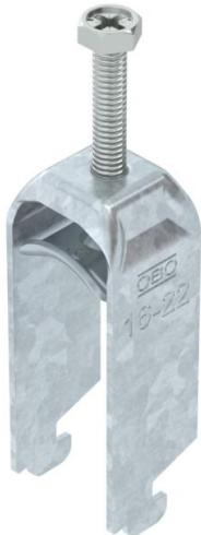
Staffa reggicavo con ancoraggio tipo N, coppa in metallo con bordi arrotondati per proteggere il cavo. Per il montaggio verticale e orizzontale di 2 cavi singoli su profilato a C. Per asola 11 - 12 mm. Con coppa di pressione, testa a vite esagonale universale SW10, intaglio a croce e a taglio. Per il montaggio in ambiente interno ed esterno. Separazione tra due cavi grazie alla coppa doppia. Si raccomanda l'uso della controcoppa.
