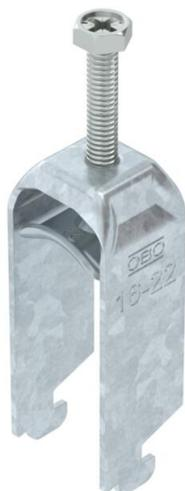
Bügelshelle mit N-Fuß, Metalldruckwanne mit gerundeten Kanten für Kabelschutz. Zur vertikalen und horizontalen Montage von 2 Einzelkabeln an C-Profilshiene. Für Schlitzweite 11 - 12 mm. Mit 1-gängiger Schraube an Druckwanne, universeller Sechskant-Schraubenkopf SW10, mit Schlitz und Kreuzschlitz. Geeignet für Montage im Innen- und Außenbereich. Mehrere Kabel sollten durch Doppelwannen getrennt werden. Der Einsatz einer Gegenwanne wird empfohlen.
