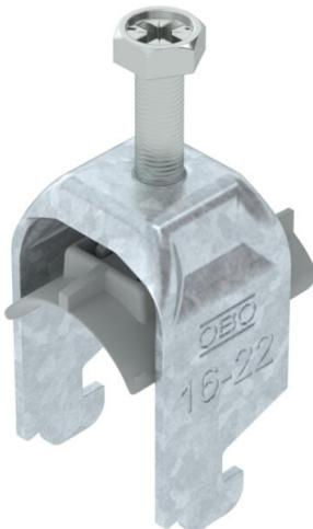
Bügelschelle mit N-Fuß, Kunststoffdruckwanne aus Polypropylen. Zur vertikalen und horizontalen Montage von 2 Einzelkabeln an C-Profilschiene. Für Schlitzweite 11 - 12 mm. Mit 1-gängiger Schraube an Druckwanne, universeller Sechskantschraubenkopf SW10, mit Schlitz und Kreuzschlitz. Geeignet für Montage im Innen- und Außenbereich. Mehrere Kabel sollten durch Doppelwannen getrennt werden. Der Einsatz einer Gegenwanne wird empfohlen.
