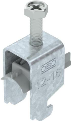
Staffa reggicavo con ancoraggio tipo N, coppa plastica in polipropilene. Per il montaggio verticale e orizzontale di 2 cavi singoli su profilato a C con scanalatura di larghezza 11 - 12 mm. Dotata di vite SW10 per il serraggio della coppa tramite testa esagonale o intaglio a croce. Per il montaggio in ambiente interno ed esterno. Separazione tra due cavi garantita dalla coppa doppia. Si raccomanda l'uso della controcoppa, da ordinare separatamente.
