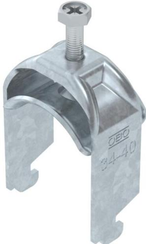
Staffa reggicavo con base a N, coppa in metallo con bordi arrotondati per proteggere il cavo. Per il montaggio verticale e orizzontale di 1 cavo singolo su profilato a C. Per dimensioni dell'asola di 11 - 12 mm. Con una vite sulla coppa premente, testa della vite esagonale universale da SW10, a taglio e a croce. Per il montaggio in ambienti interni ed esterni. Si consiglia di utilizzare una controcoppa.
