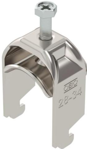
Staffa reggicavo con ancoraggio tipo N, coppa in metallo con bordi arrotondati per proteggere il cavo. Per il montaggio verticale e orizzontale di 1 cavo singolo su profiliato a C. Per asola 11 - 12 mm. Con coppa di pressione, testa a vite esagonale universale SW10, intaglio a croce e a taglio. Per il montaggio in ambiente interno ed esterno. Si raccomanda l'uso della controcoppa.
