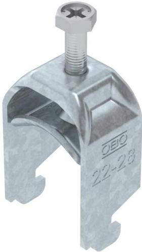
Staffa reggicavo con base a N, coppa in metallo con bordi arrotondati per proteggere il cavo. Per il montaggio verticale e orizzontale di 1 cavo singolo su profilato a C. Per dimensioni dell'asola di 11 - 12 mm. Con una vite sulla coppa premente, testa della vite esagonale universale da SW10, a taglio e a croce. Per il montaggio in ambienti interni ed esterni. Si consiglia di utilizzare una controcoppa.
