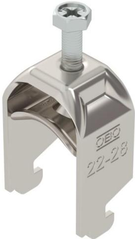
Bügelschelle mit N-Fuß, Metalldruckwanne mit gerundeten Kanten für Kabelschutz. Zur vertikalen und horizontalen Montage von 1 Einzelkabel an C-Profil-schiene. Für Schlitzweite 11 - 12 mm. Mit 1-gängiger Schraube an Druckwanne, universeller Sechskant-Schraubenkopf SW10, mit Schlitz und Kreuzschlitz. Geeignet für Montage im Innen- und Außenbereich. Der Einsatz einer Gegenwanne wird empfohlen.
