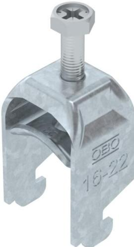
Staffa reggicavo con base a N, coppa in metallo con bordi arrotondati per proteggere il cavo. Per il montaggio verticale e orizzontale di 1 cavo singolo su profilato a C. Per dimensioni dell'asola di 11 - 12 mm. Con una vite sulla coppa premente, testa della vite esagonale universale da SW10, a taglio e a croce. Per il montaggio in ambienti interni ed esterni. Si consiglia di utilizzare una controcoppa.
